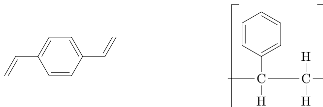
Figure 16 Formule du divinylbenzène et motif du polystyrène
