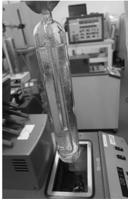
Figure 3 Cellule point triple de l'eau
