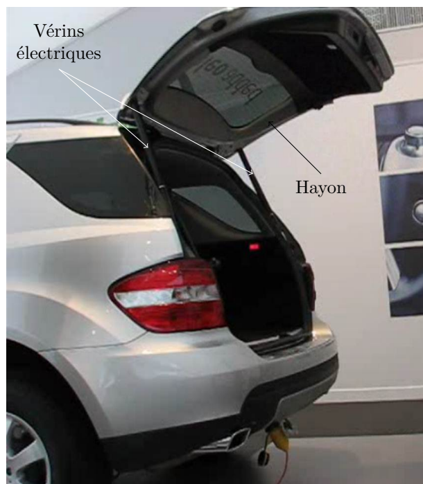
Figure 2 Description d'un hayon
