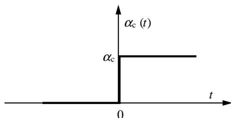
29. On réalise le circuit d'asservissement de vitesse schématisé sur la figure ci-contre :  $\alpha_c(t)$  désigne la grandeur de consigne, ici égale à un échelon caractérisé par  $t < 0$ ,  $\alpha_c(t) = 0$  et  $t \geq 0$ ,  $\alpha_c(t) = \alpha_c$ . Un capteur de vitesse permet de comparer la grandeur ramenée proportionnelle
