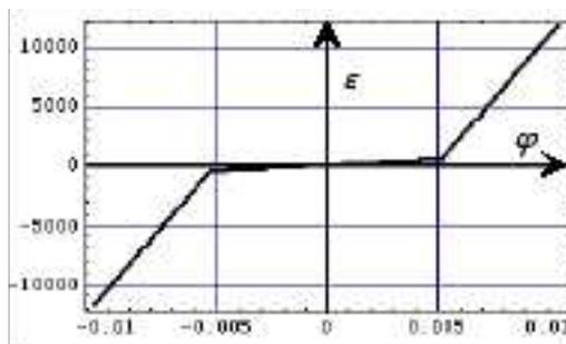
Les enroulements primaire et secondaire d'un transformateur possèdent respectivement  $N_p$  et  $N_s$  spires, dont on négligera la résistance. On nomme  $\varphi$  le flux dans une section  $S$  du circuit magnétique sur lequel ces spires sont bobinées. La caractéristique idéale du circuit magnétique  $\varepsilon(\varphi)$ , représentée ci-contre, est définie par les relations
