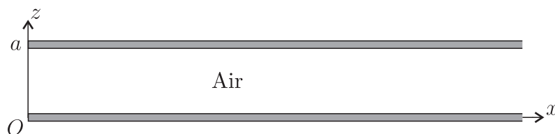
FIGURE 6 – Modèle plan de guide d'onde acoustique.
