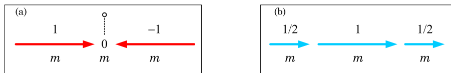
FIGURE 7 – Deux modes de vibration ; les amplitudes vibratoires sont indiquées en unités relatives.
