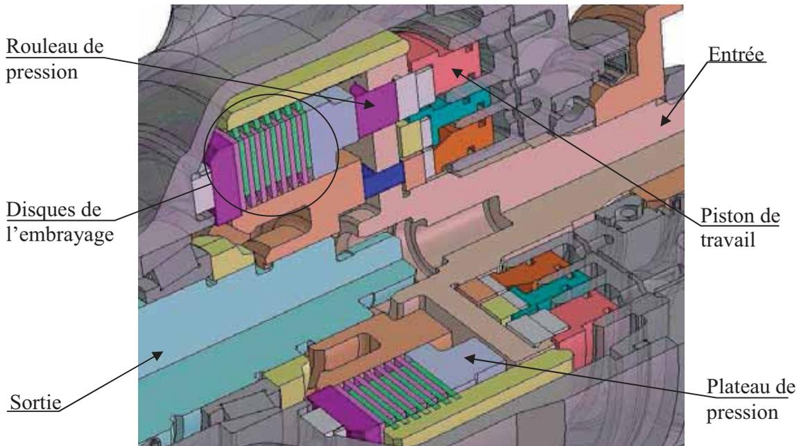
Figure 15 : description de l'embrayage multi disques
