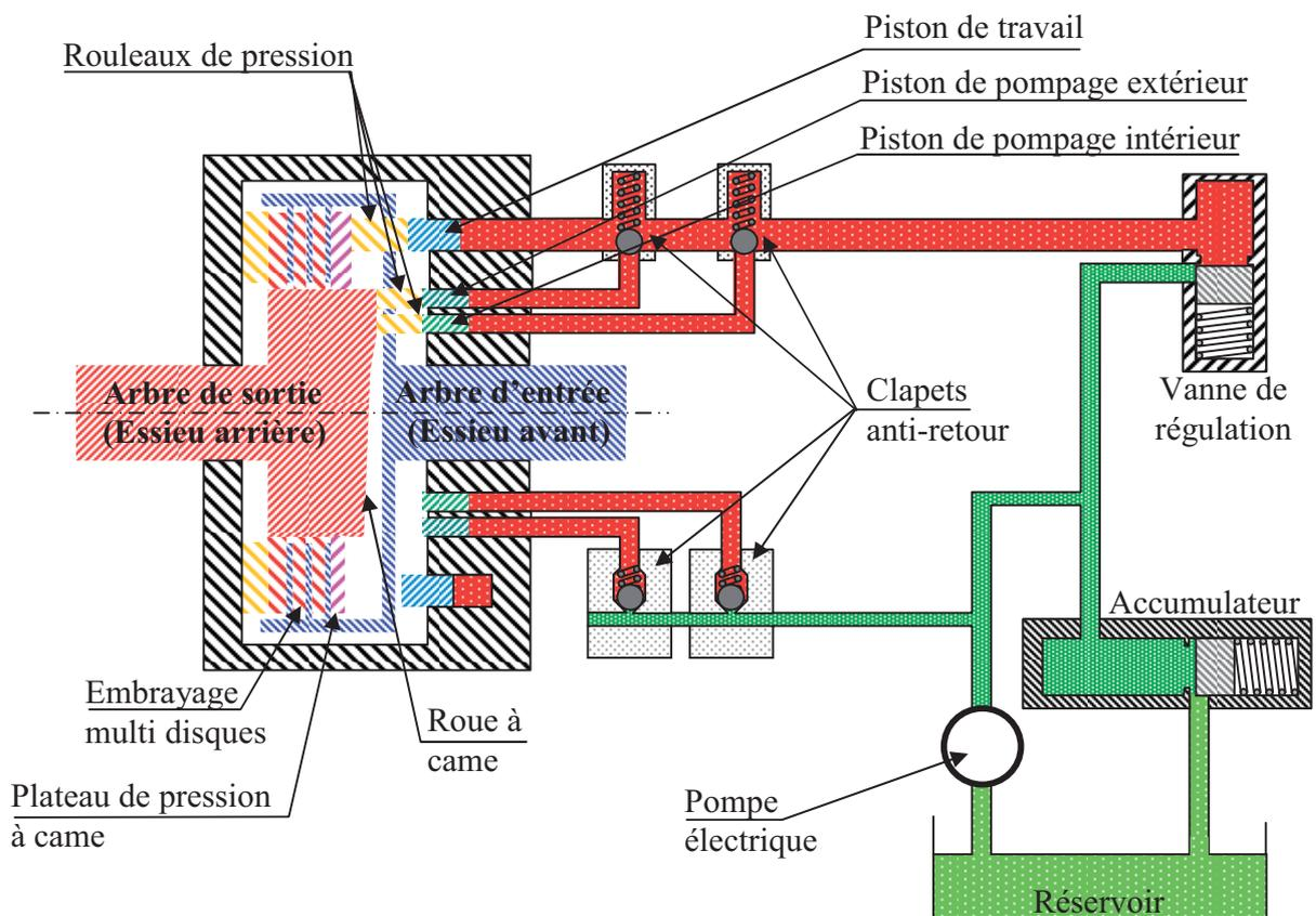
Figure 9 : description de la partie hydraulique de l'Haldex
