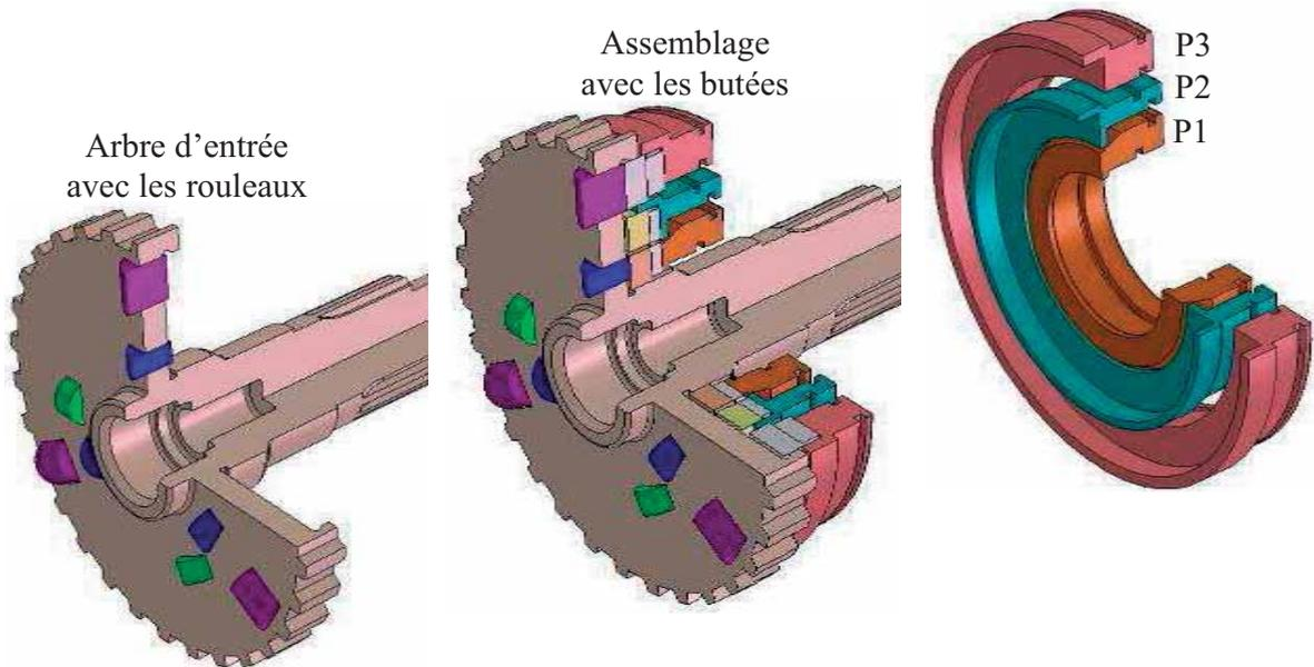
Figure 13 : assemblage de l'arbre d'entrée avec les 3 pistons
