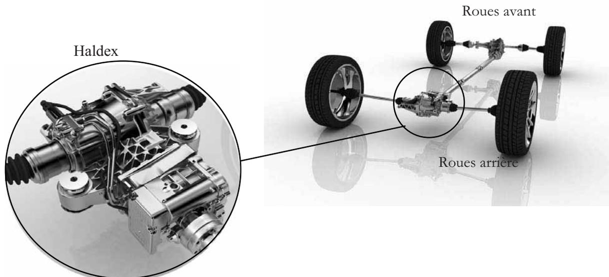
Figure 4 : implantation de la transmission «4Motion »
