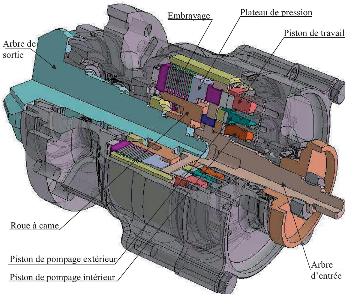
Figure 8 : description de la partie mécanique de l'Haldex
