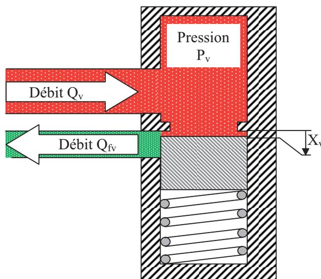
Figure 10 : vanne de régulation
