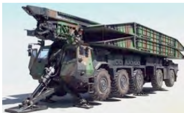
Figure 12 : ponteur en appui sur les stabilisateurs
