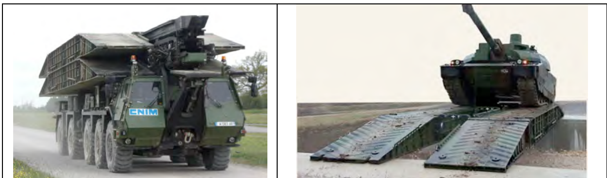
Figure 2 : Ponteur chargé de quatre travures (gauche) et travures assemblées permettant le franchissement d'une brèche (droite)
