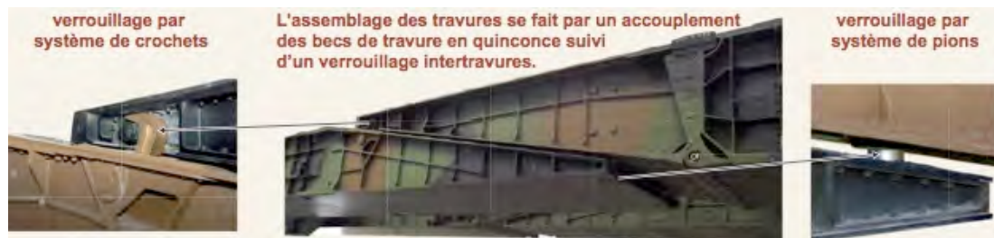
Figure 18 : représentation du système de verrouillage inter-travures
