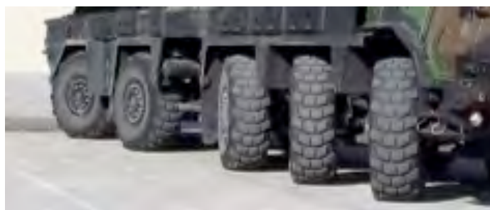
Figure 4 : système à cinq essieux constituant le ponteur
