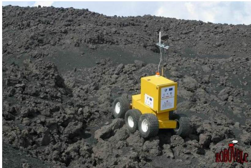
Figure 10 : illustration du comportement de ROBOVOLC sur terrain accidenté
